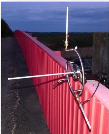
Figure 3 : Antenne Cyberio en position ouverte, le micro n°1 est en bas à gauche, le n°2 est au centre positionné horizontalement, le n°3 est en bas à droite et le n°4 en haut.
